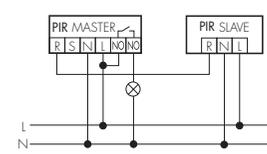
Agrandissement de la zone de détection avec un ou plusieurs appareils Slave. Attention: L'appareil Master doit toujours être monté à l'endroit où la quantité de lumière est la plus faible.
