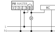
En cas d'enclenchement d'inductances parallèles au réseau (lampes fluo-escences, relais, etc.), un circuit RC peut être nécessaire.
